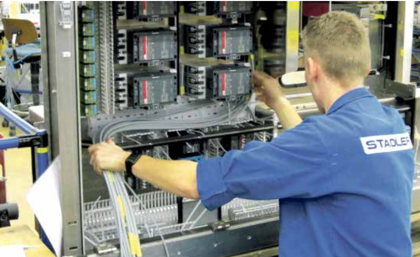
Stärkung des dualen Bildungssystems: Automatiker im 4. Lehrjahr beim Verdrahten eines 400-V-Steuer-schranks für ein Schienenfahrzeug für den Regionalverkehr.
