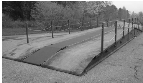
Das Brückenlegesystem im Einsatz 26-Meter-Brückensatz mit Mittenabdeckung / Geländer
