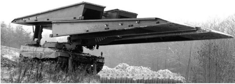
Brückenlegesystem beim Verlegen der 26-Meter-Brücke
