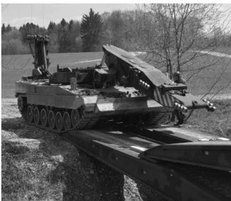
Das Brückenlegesystem im Einsatz 26-Meter-Brückensatz mit Mittenabdeckung / Geländer
