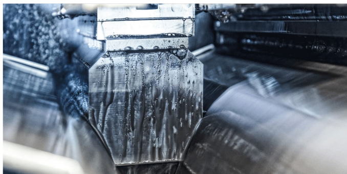
Figure 8 : À gauche, répartitions de fabricants d'équipements pour la production photovoltaïque. À droite, un exemple de la participation majeure de l'industrie suisse : scie à fil diamanté développée par l'entreprise suisse Meyer Burger SA et utilisée pour découper les blocs de silicium en tranches (wafers). Ces scies permettent de réduire fortement les pertes lors de la fabrication des wafers. Cette technologie est aujourd'hui un standard (source : AIE, photo : Meyer Burger SA).
