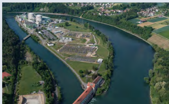
Das Kernkraftwerk Beznau im Kanton Aargau entnimmt zwecks Kühlung Wasser aus der Aare. Dieses wird erwärmt wieder in den Fluss geleitet und kann so im Sommer eine Gefahr für das Ökosystem darstellen. Foto: Urs Hubacher / Keystone
